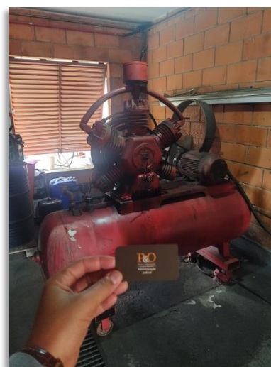
Foto 12: Casa de máquinas, onde fica os compressores de Ar para atender a linha de produção
