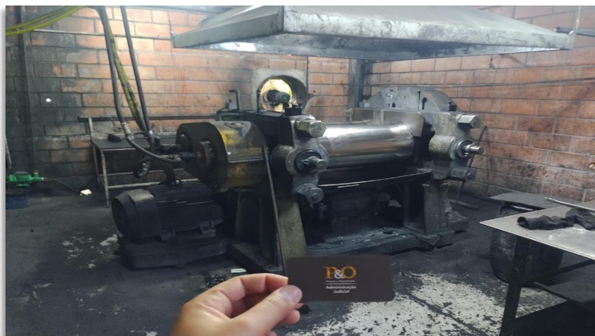
Foto 24: Setor de Mistura, local onde ocorre o processo de transformação da borracha
